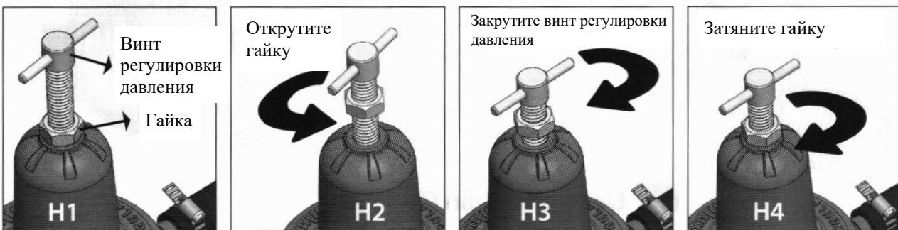
Открутите гайку (рисунок Н2), закрутите винт регулировки давления вниз, чтобы повысить давление (рисунок Н3). По окончании регулировки давления закрутите гайку, чтобы зафиксировать винт регулировки давления в текущем положении (рисунок Н4).
