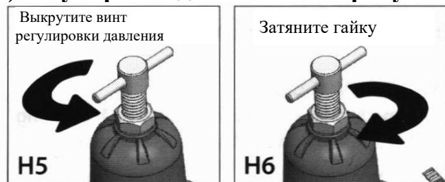
Выкрутите винт регулировки давления вверх, чтобы понизить давление (рисунок Н5). По окончании регулировки давления закрутите гайку, чтобы зафиксировать винт регулировки давления в текущем положении (рисунок Н6).
